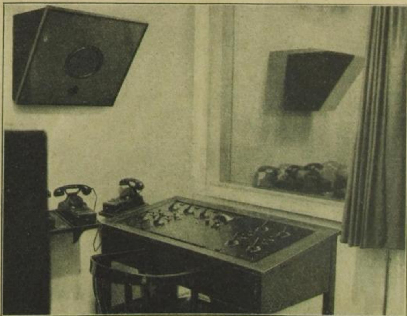
Abb. 8. Eine ganz besondere Bedeutung fällt dem Tonmixer zu, der mit Hilfe dieses Mischpultes seines oft ungemein schweren Amtes waltet
