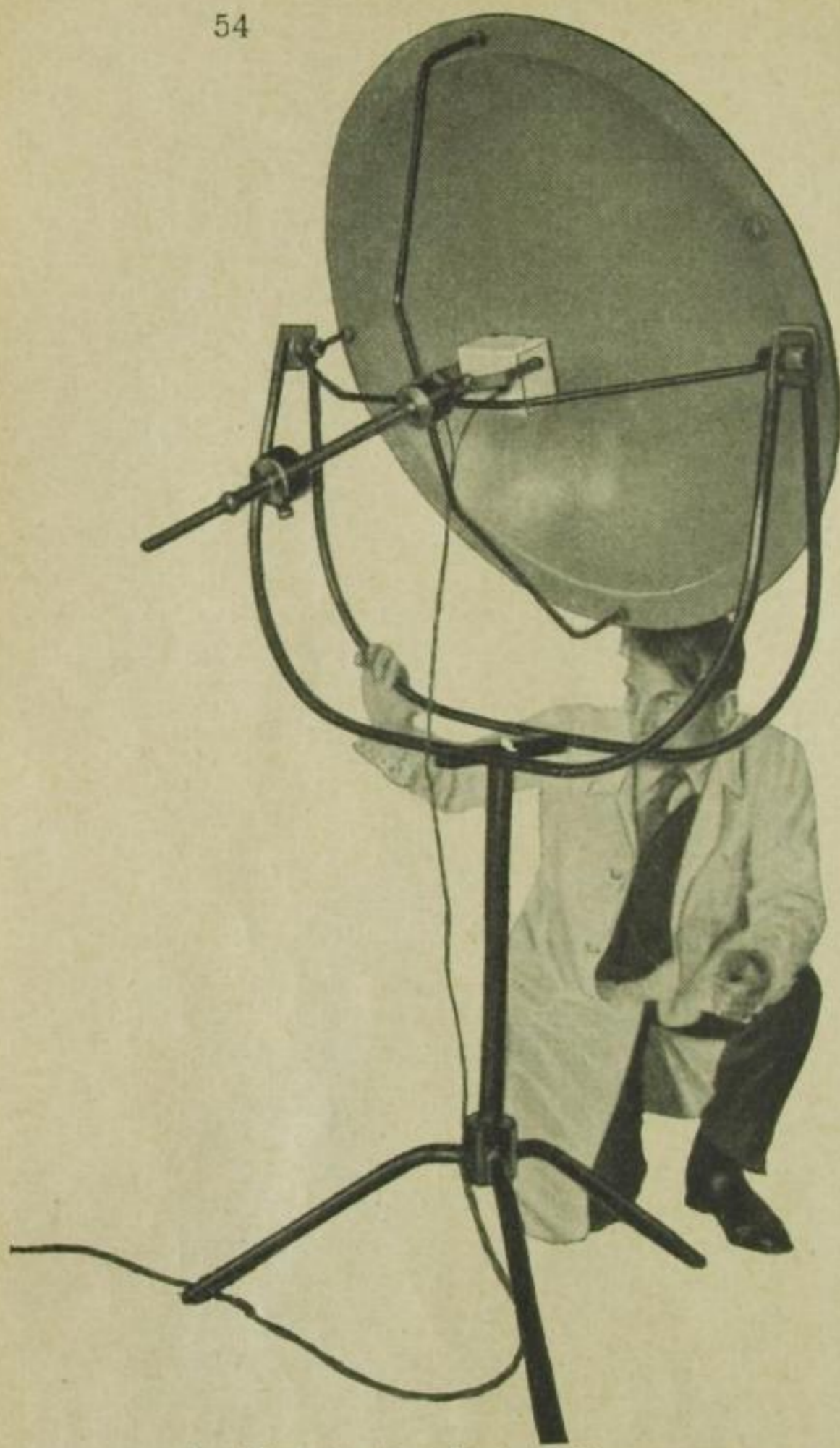
Im Haus des Rundfunks befinden sich auch riesige Laboratorien der Reichsrundfunkgesellschaft, wo alle Apparate, die irgendwie im Sendebetrieb Verwendung finden, geprüft werden. Unser Bild zeigt ein sogenanntes Richtmikrophon, das besonders bei Übertragungen aus den Theatern Verwendung finden soll. Es wird ähnlich wie ein Scheinwerfer auf den Schauspieler oder Sänger eingestellt und folgt ihm in allen seinen Bewegungen, so daß es den Ton stets richtig aufnimmt
