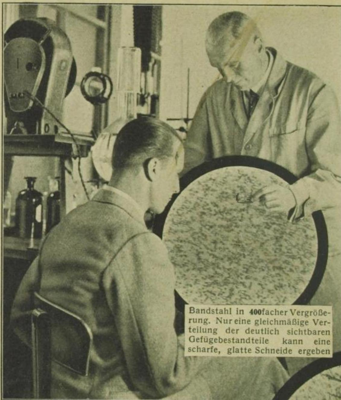
Bandstahl in 400facher Vergrößerung. Nur eine gleichmäßige Verteilung der deutlich sichtbaren Gefügebestandteile kann eine scharfe, glatte Schneide ergeben
