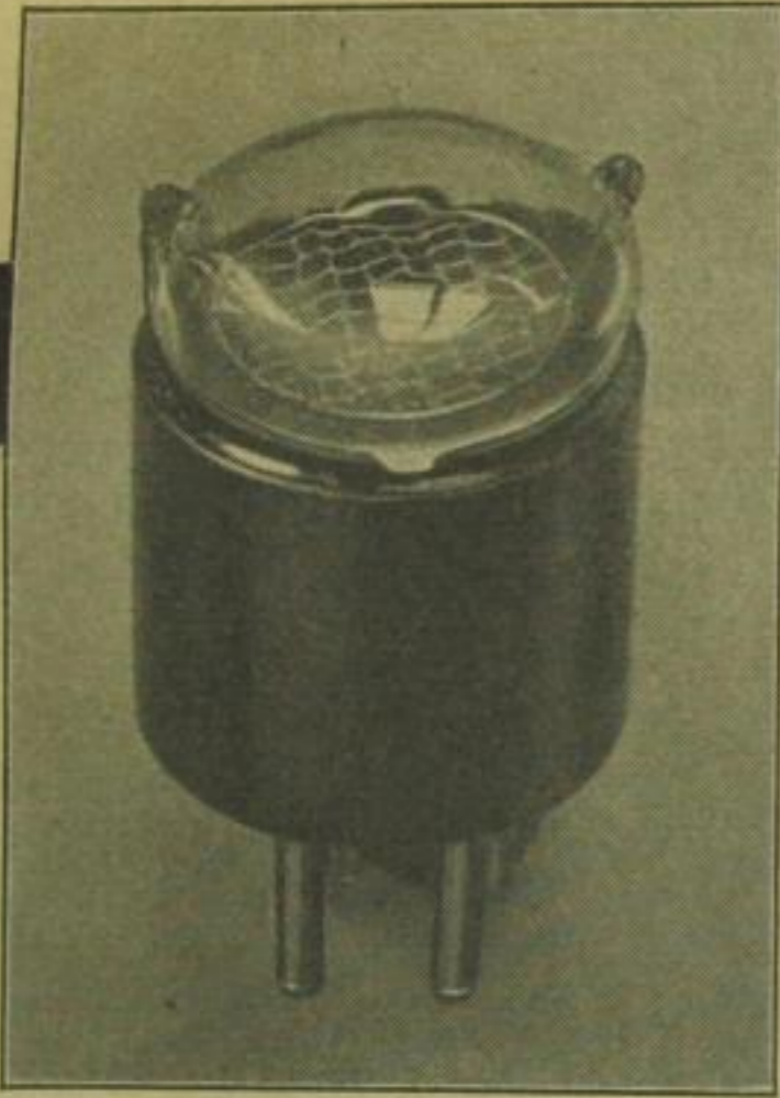
Einfache Photozelle für viele Zwecke
