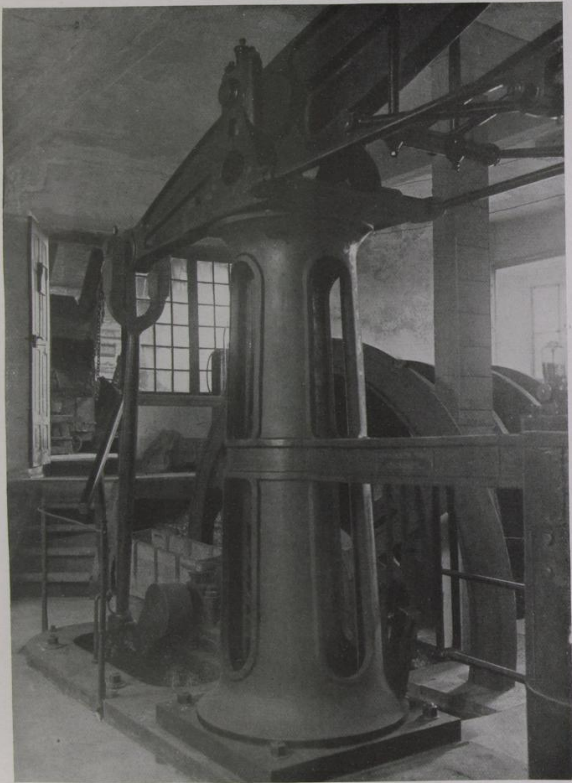
Abb. 8. Die im Jahre 1847 erbaute Balancierfördermaschine der Alten Elisabeth
