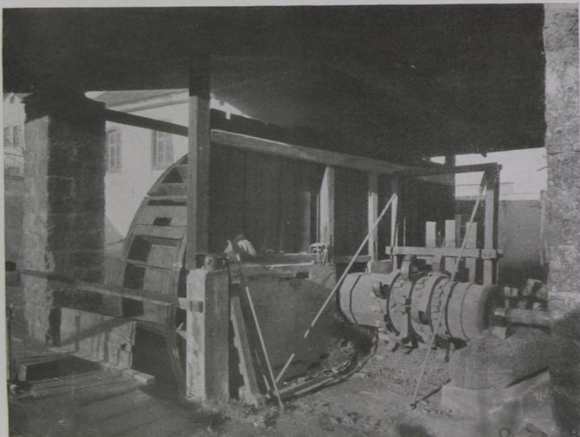
Abb. 5. Das Schlackenpochwerk im Pfeilhammer (Wasserrad, Welle und Pochstempel)
