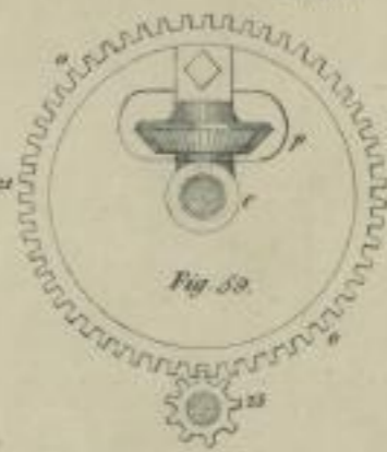
Ausgleichungs-Mechanismus. Maassstab \frac{1}{2} Zoll = 1 Fuss.
