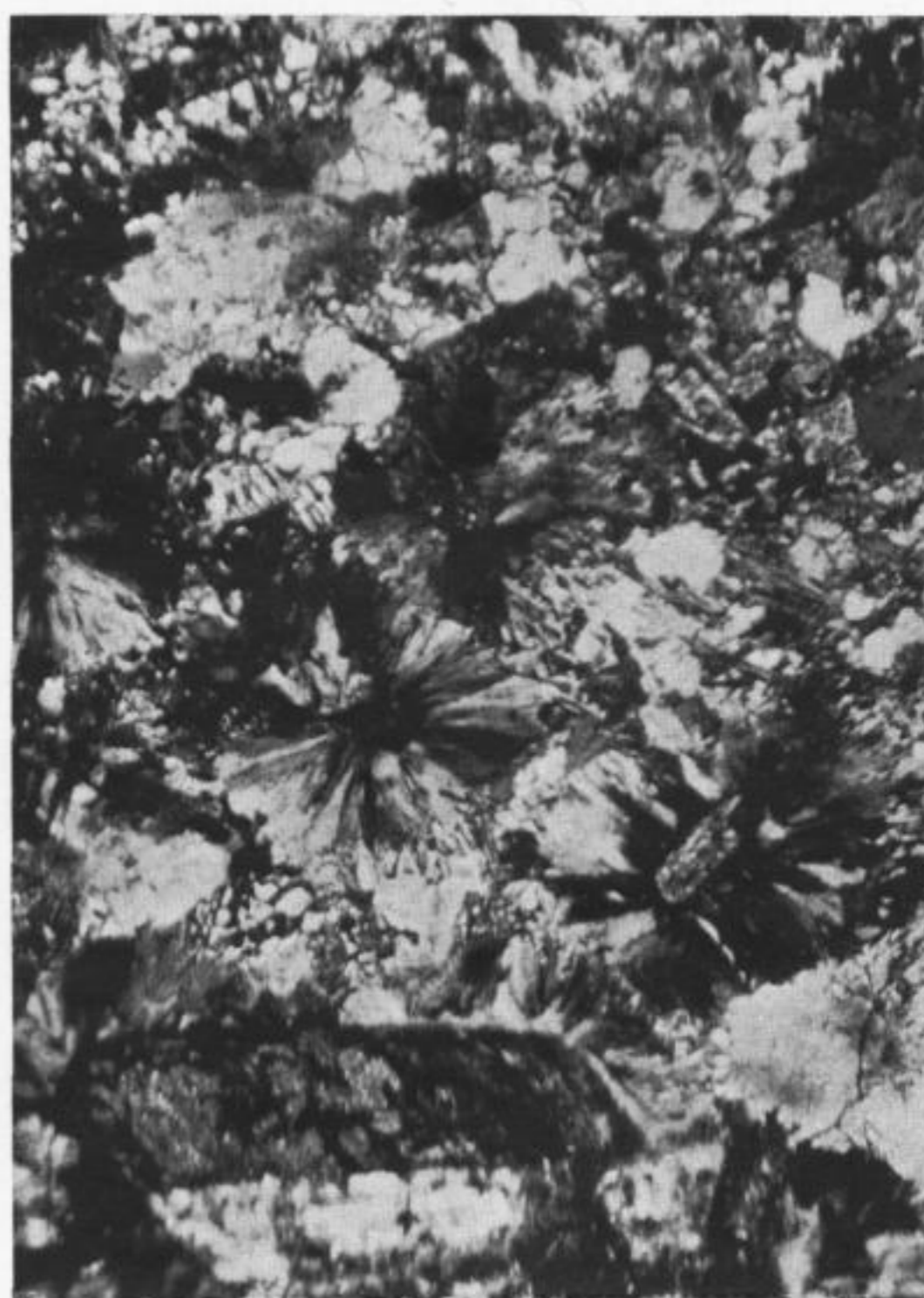
Abb. 76. 1 mm große Pseudosphärolithe aus Quarz- feldspatnadeln, mit Übergang zu Graphophyr- strukturen. Schl. 3120, + Nic. Vergr. 25 ×.
