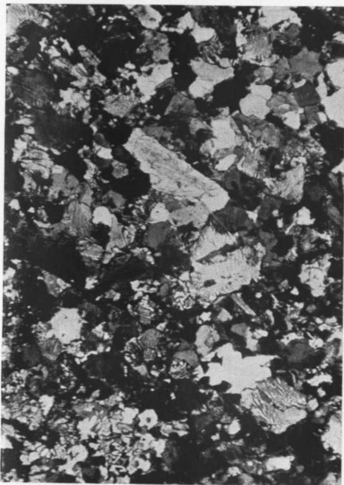
Abb. 71. Feinkörniger Aplit, Typ B 4 . Starke Beteiligung graphophyrischer Baueinheiten. Höhe 548.8 b. Ottengrün. Schl. 4166, + Nic. Vergr. 45 ×.
