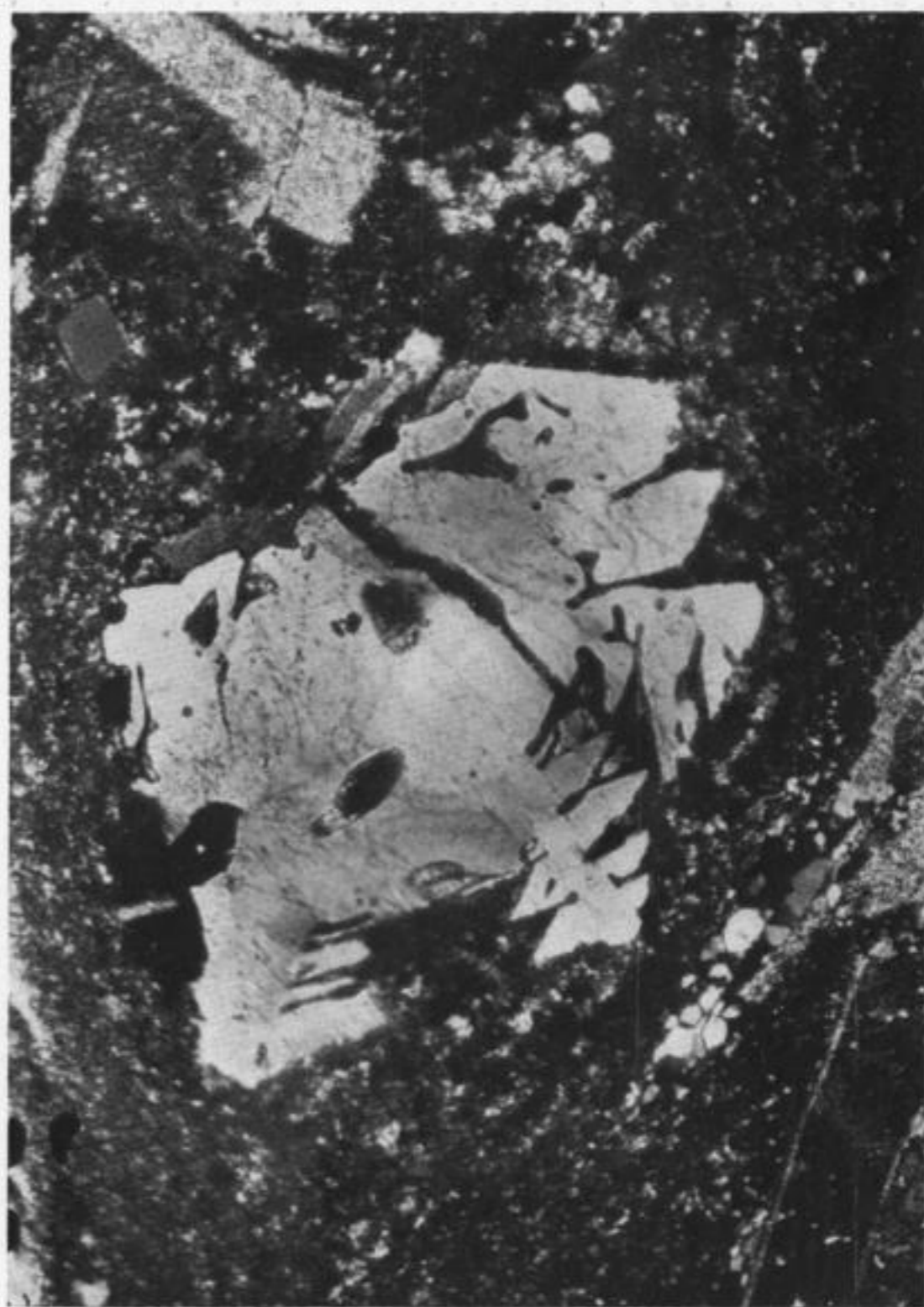
Abb. 80. Quarzeinsprengling in Skelettforn als unvollendete Wachstumserscheinung. Schl. 4507. + Nic. Vergr. 20 \times .
