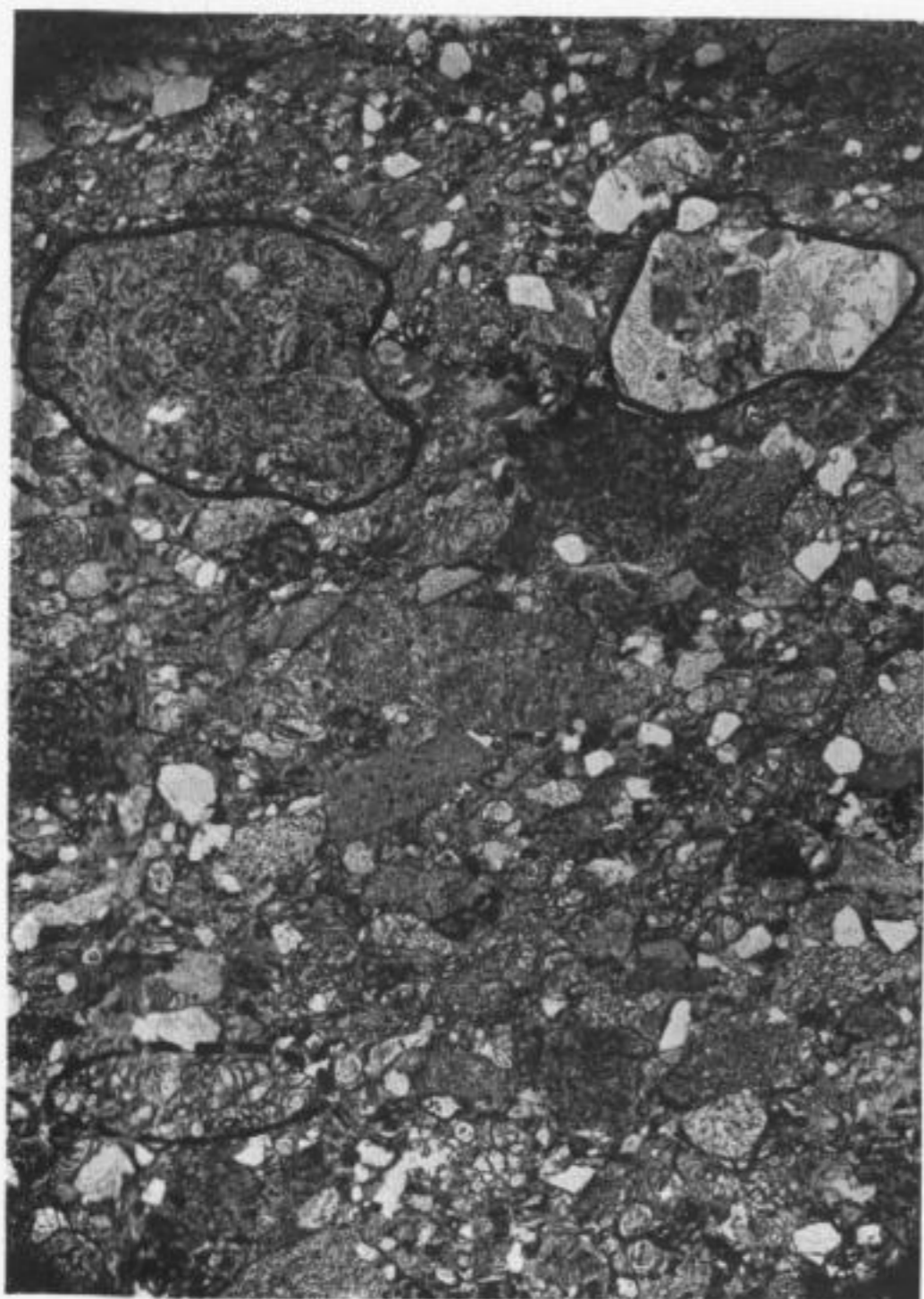
Abb. 59. Aus großen grünlichen Blöcken direkt an den Reitzensteiner Konglomeratfelsen. Ge- rölle von Granit (rechts) und Diabas (links oben) in Diabaslavazement mit glasigen Perlitstruk- turen (unten).
