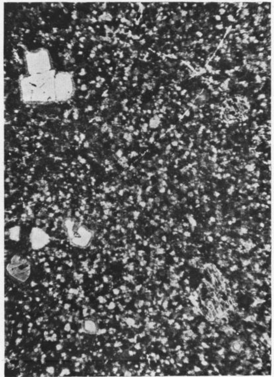
Abb. 84. Quarzporphyr. Quarzeinsprenglinge mit Koronen. Grundmasse feinstgraphophyrisch. W. Raschau. Schl. 3138, + Nic. Vergr. 12 ×.
