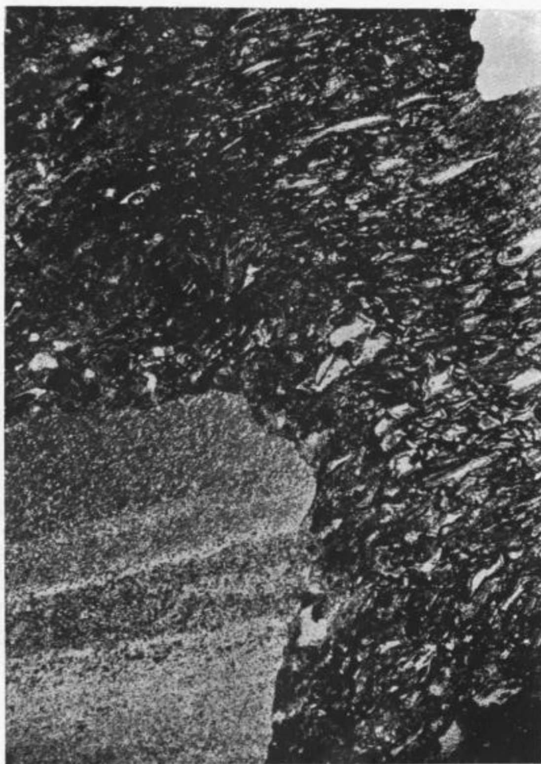
Abb. 54. Aus verlassenen Stbr. WSW-Seite des Schönbühl. Diabasaschentuff mit Aschenstrukturen und Tonschieferfragment (Hüllmaterial von feinkörnigen Granit-Graphopyrgranitgeröllen).
