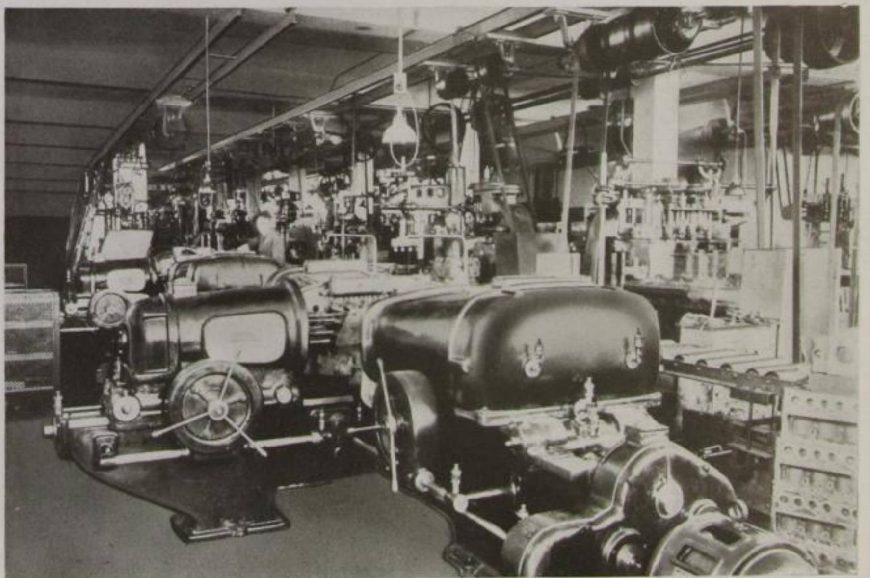
Bohrmaschine für vielfache, gleichzeitig auszuführende Bohrgänge (Rechts vorn rollendes Transportband)
