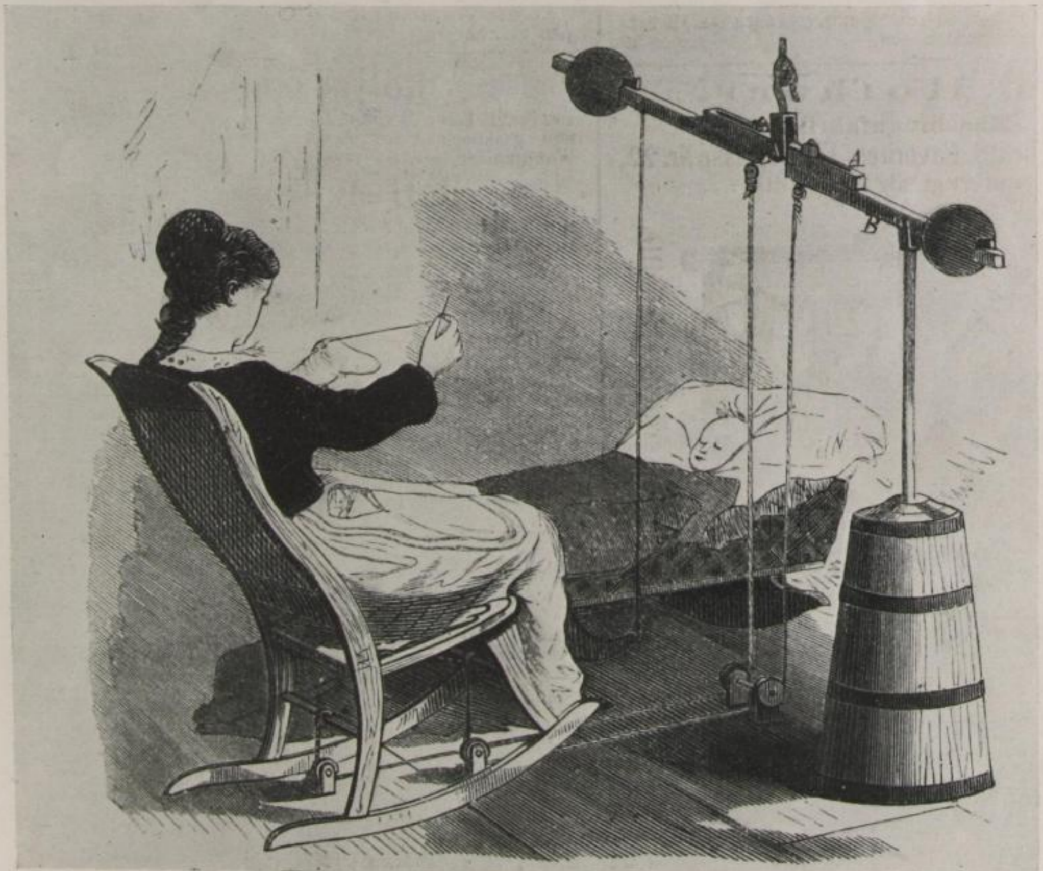
Patentirte Pferdelokomotive. Clemens Mazeranos (1850) — Unten: Schaukelstuhl als Motor für Wiege und Butterfaß, 70 Jahre
