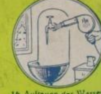
16. Auftauen der Wasserleitung
