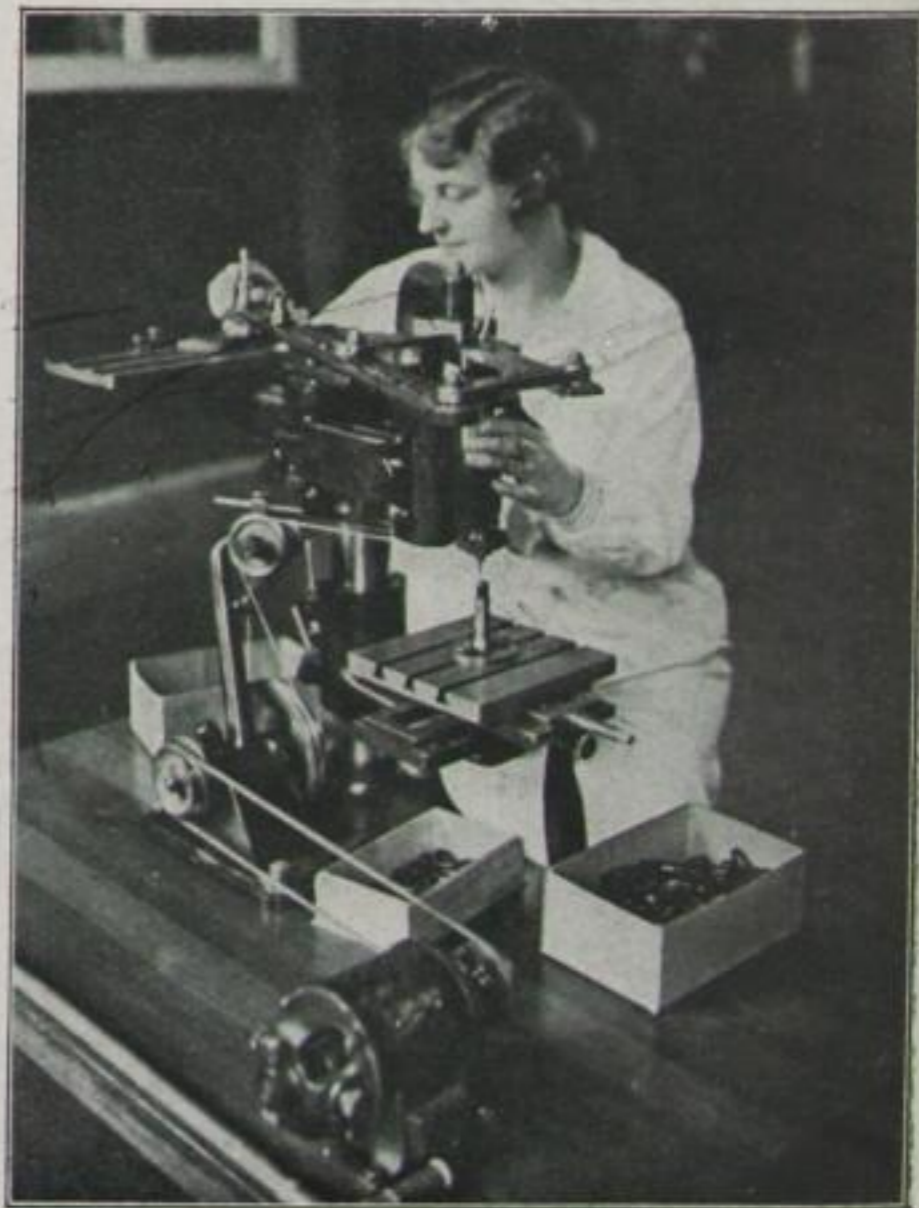
Graviermaschine, Leistung 1000 Stck. pro 8 Stunden
