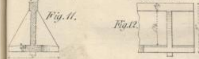
Durchschnitt des Trägers H. Das äusserste Ende des Trägers H gegen die Mauer
