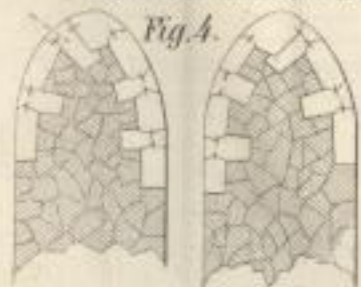
Steinverband in den Vorköpfen des reinen Mauerwerks.
