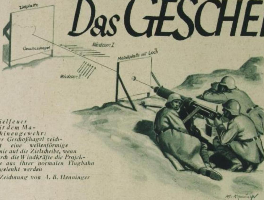
Zielfeuer mit dem Maschinengewehr: Der Geschosshagel zeichnet eine wellenförmige Linie auf die Zielscheibe, wenn durch die Windkräfte die Projektile aus ihrer normalen Flugbahn abgelenkt werden.
