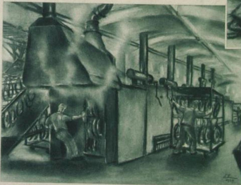
„Einbrennofen für lackierte Teile“ (Rahmen, Tanks,
