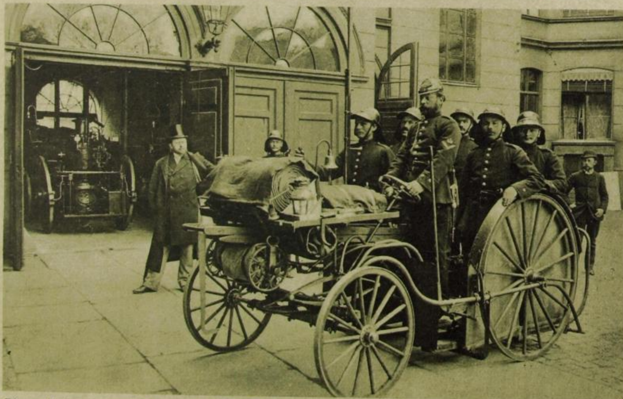
Diesen Tretmotorwagen ließ sich die Berliner Feuerwehr 1894 von Ganswindt bauen. — Der Benzinmotor war damals noch nicht gebrauchsfähig, und so baute der Erfinder den Tretmotor in dutzender Anwendungsförm. Ungeheures Aufsehen erregten solche Vehikel bei ihren Fahrten; das neugierige Publikum verstopfte die Straßen, so daß die Polizei den Erfinder ersuchte, jede Fahrt vorher anzumelden.
