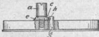
uhren, an der Unterlage mit durch diese hindurchtretenden, am Zifferblatt befestigten Pfeiler, dadurch gekennzeichnet, daß auf der neben dem Pfeiler (g) in die Unterlage eingeschraubten, an sich bekannten Schraube (a) eine lose Platte (e) sitzt, die beim Anziehen der Schraube (a) von dieser zentriert wird und dadurch mit ihrem in die Aussparung (b) des Pfeilers (g) eintretenden keilförmigen Rande den Pfeiler in die Höhe zieht.
