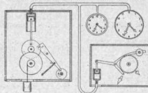
Organen übertragen wird, dadurch gekennzeichnet, daß zur Erzeugung und zur Aufnahme des Druckes in Zylindern bewegliche, nicht ganz dicht schließende Metallkolben dienen und die Übertragung der Druckschwankungen durch eine Leitung bewirkt wird, die für jede anzutreibende Uhr weniger als 1 gmm Querschnitt besitzt, um die schädliche Wirkung von Elastizität und Temperatur auf die Luftsäule zu verhindern.
