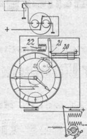
Patent 410162, gekennzeichnet durch einen Hilfskontakt (20, 21), vermittels dessen der Magnet (22) beim Regelungsvorgang so lange an eine Stromquelle angeschlossen wird, bis die Regelung des Uhrwerkes völlig beendet ist. (IX/53)
