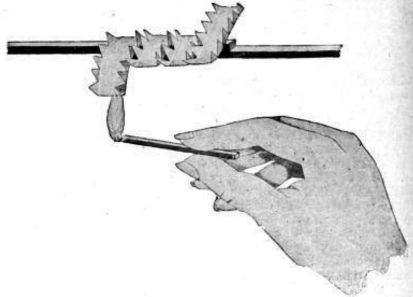
Stück Lötband, Metallseite auf die Lötstelle, spiralenförmig umwickelt, worauf dann das Lötband durch eine Flamme angezündet wird. Nach dem Verbrennen ist die Lötung vollzogen. Ein Bund Lötbander zu 25 Stück von je 10 cm Länge kostet 1,25 Mk., ein Dutzend 0,65 Mk., ein einzelnes Band zur Probe 0,10 Mk.
