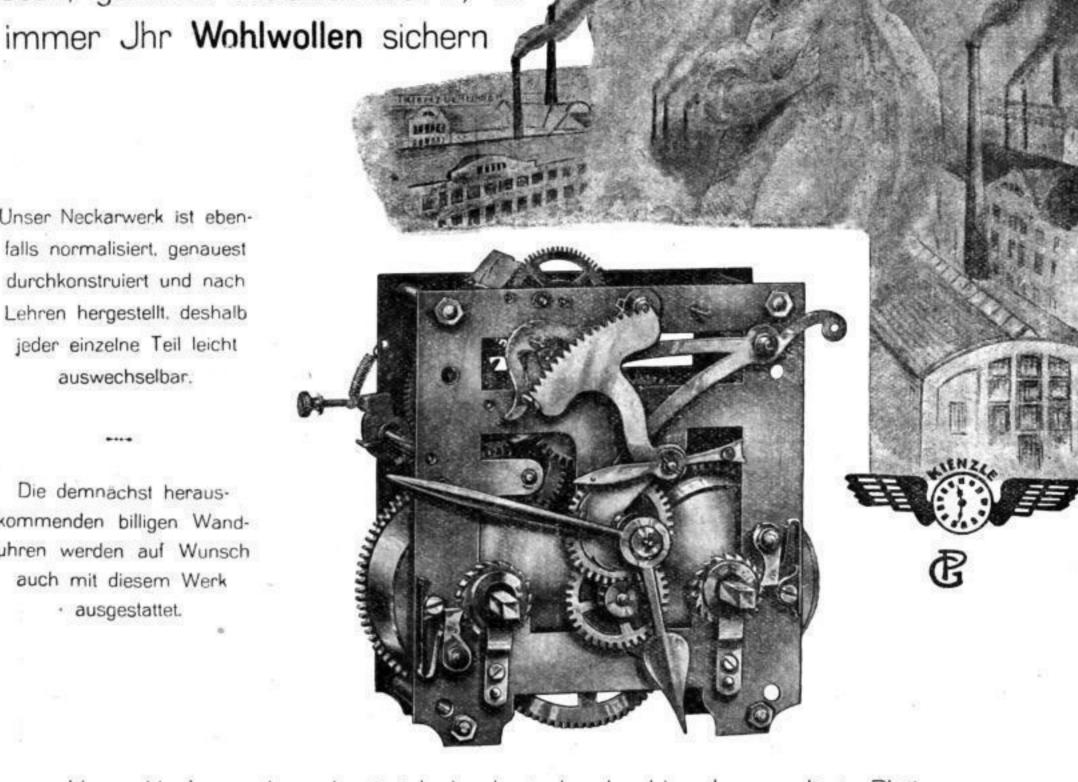
Unser Neckarwerk zeichnet sich durch starke, durchbrochene, polierte Platinen, fein polierte Stahlvolltriebe. Grahamgang mit Messinganker und eingesetzten polierten Stahlpaletten aus. :: Konstruktive Einfachheit des Rechens gewährleistet Zuverlassigkeit beim Schlagen. .: Das Regeln des Pendelabfalles geschieht mittelst einfacher Vorrichtung durch leichten Druck an der Gabelführung.
