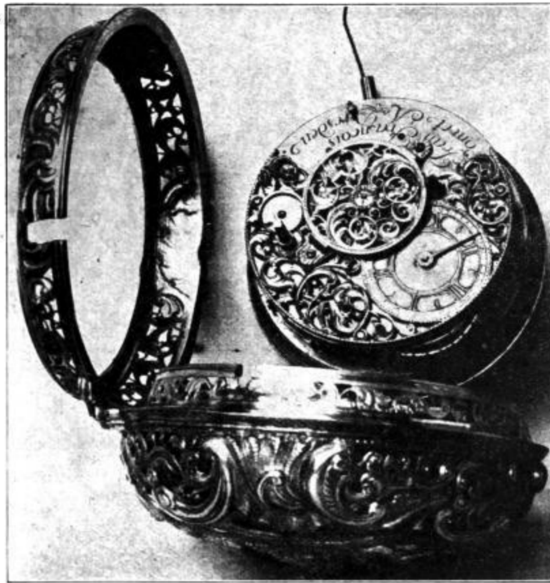
Reisewagenuhr , Silber getrieben, mit Wecker und Zugrepetition. Von J. Fr. Poncet, Dresden. Um 1750. Vormalig Sammlung Pleißner. Mathematischer Salon.
