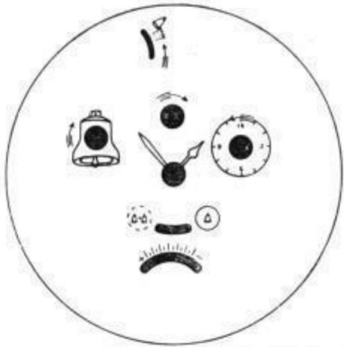
Bestehende Abbildung zeigt eine Weckerrückwand mit den neuen Bezeichnungen. Jede Erklärung ist überflüssig! Auch ein Kind wird begreifen, daß der mittlere Knopf mit dem Zeigerbild zum Stellen der Uhrzeiger dient, und ob er das Gehwerk oder das Läutewerk aufzieht, wird selbst jedem Analphabeten begreiflich sein, wenn er bei dem Aufzugschlüssel das Bild der Glocke bzw. der Uhr sieht.
