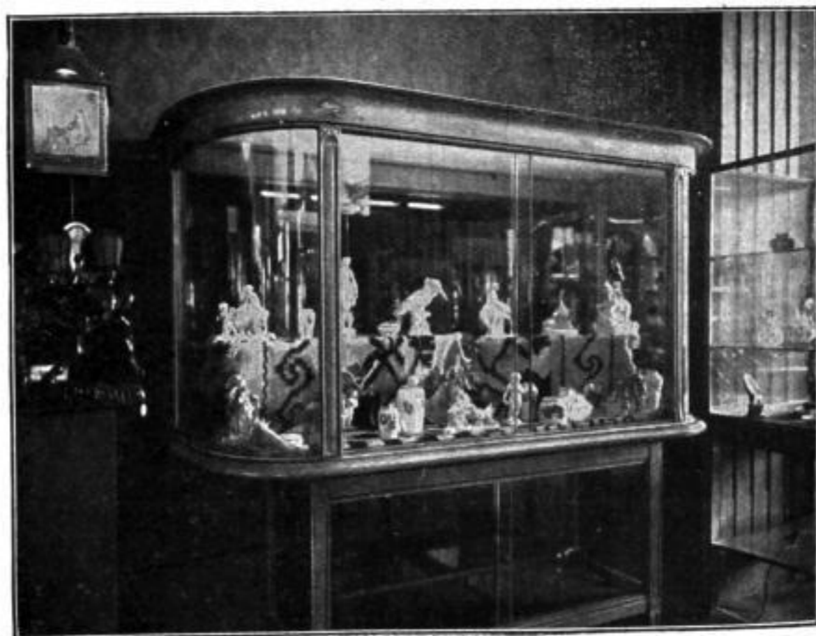
Abb. 2. Die Lampen spiegeln sich in der Glasrückwand des Schaukastens, weil dieser dicht an einer dunklen Wand steht
