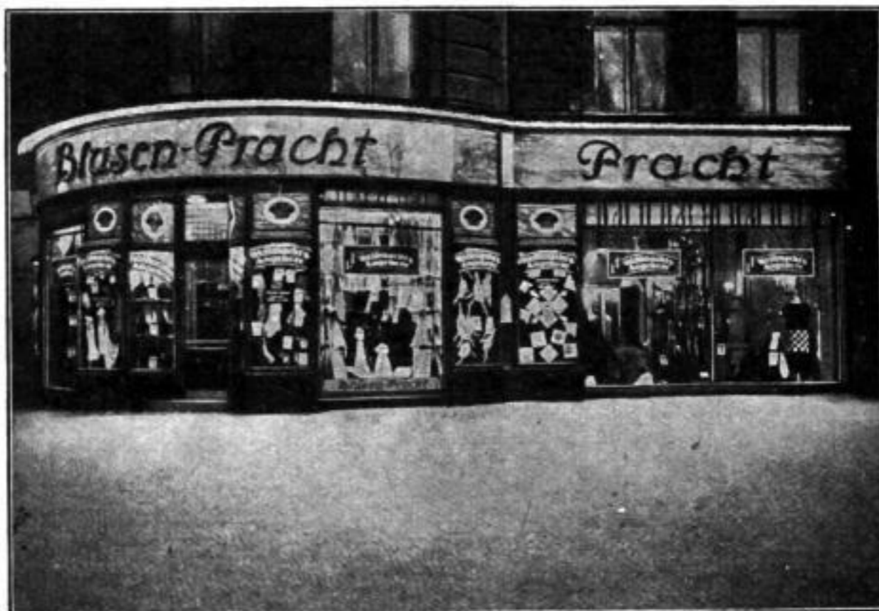
Abb. 9. Firmenschildaufnahme bei Nacht. Beleuchtung durch Soffittenlampen, welche für den Beschauer unsichtbar angebracht sind
