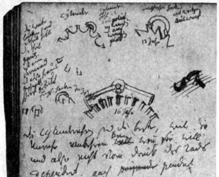
Abb. 9. Skizzen zu Uhrhemmungen, Zylinder- und Hackengang. Aus Hahns technischen Notizbüchern.
