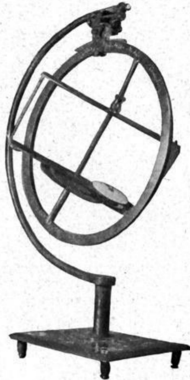
Abb. 12. Aquatoreale Ohr-Sonnenuhr mit Minutenablesung, gefertigt und bezeichnet: Gottfried Hahn (Ludwigsburg). Im Besitz des Landesgewerbemuseums Stuttgart.
