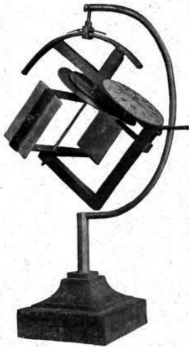
Abb. 10. Aquatoreale Ohr-Sonnenuhr mit Zeitgleichungskurve u. emalliertem Minutenzifferblatt, gefertigt von Ph. Matth. Hahn. Im Besitz der Sternwarte Königsstuhl bei Heidelberg.
