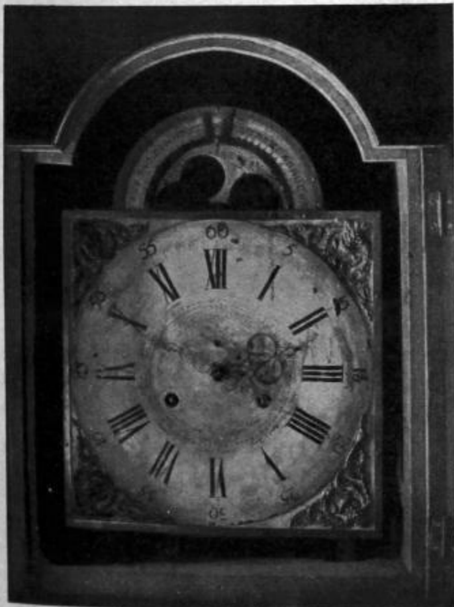
Abb. 27 Zifferblatt einer Kastenuhr mit Jahrgang, Kalenderwerk und Zeitgleichung von Ph. M. Hahn Besitzer: Oberstleutnant K. Spang, Ellwangen a. L.
