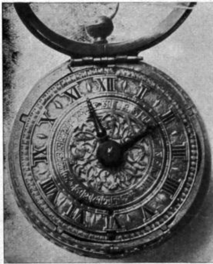
Abb. 6. Bronze-Satteluhr, frühestes Vorkommen des Minutenzeigers. Meisterbezeichnung: „Coquai“. Um 1670, 68 mm Durchmesser, 38 mm Dicke. Staatl. Mathematisch-Physikalischer Salon, Dresden
