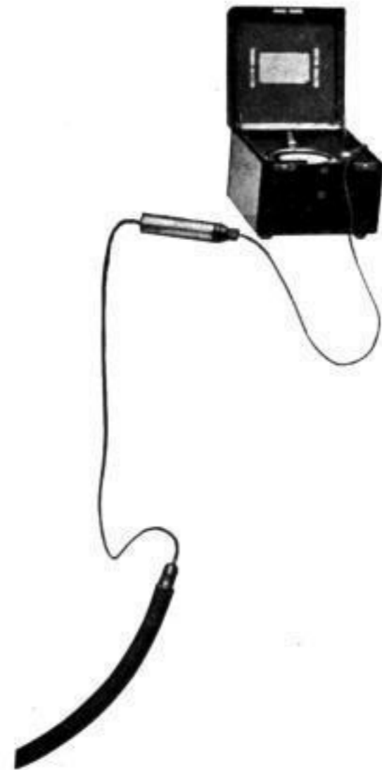
Abb. 7. Chronograph mit Elektro-Tinten-Punktierer Marinechronometer mit Gangschein (Excelsior-Park, St. Imier)
