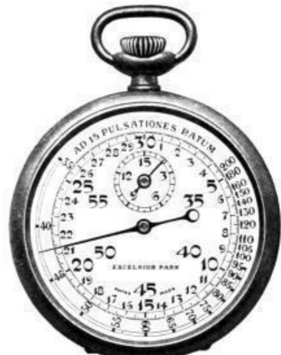
Abb. 9. Pulsmesser 1/10 Sek.-Teilung (Excelsior-Park, St. Imier)
