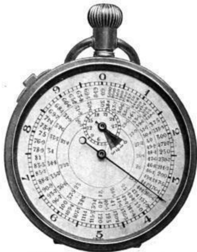
Abb. 1. Taylor-Stoppuhr Mit dieser Uhr kann man sofort nach der Dauer der Einzelleistung die Arbeitsleistung in der Stunde feststellen (Excelsior-Park, St. Imier)
