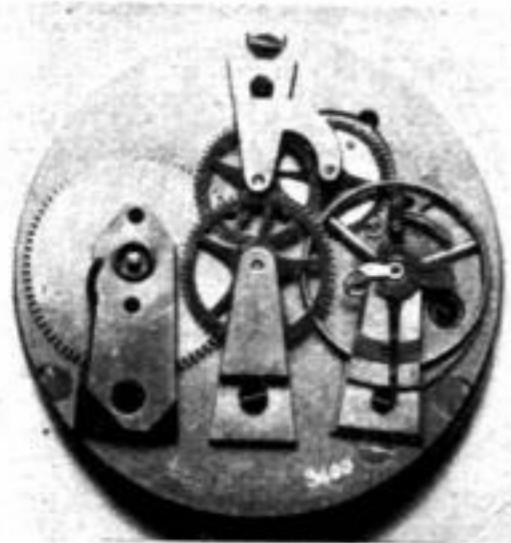
Abb. 11. Werkseite Ungewöhnliche Anordnung der Räder
