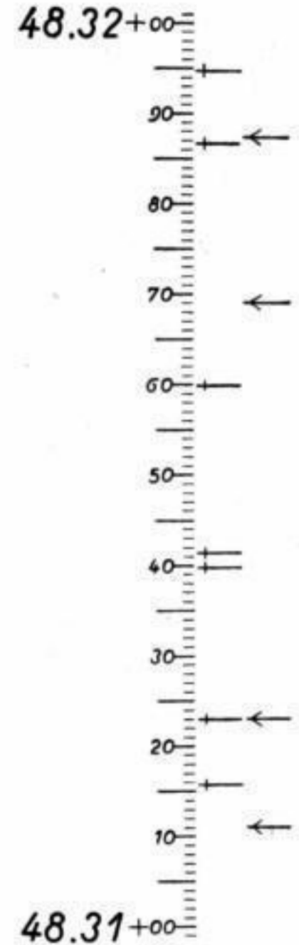
Abb. 3, Modell B mit zwei Registriervorrichtungen ohne Numerierwerk, Sekundenlänge 10 cm.
