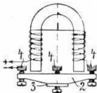
angezogenem Zustand in zwei oder mehr Punkten magnetisch isoliert auf den Polen des zugehörigen Magneten oder auf besonderen Magneten und elektrisch isolierten Lagerstellen (j) einstellbar aufliegt, so daß der Abstand nach erfolgter Einstellung stets derselbe bleibt und zwischen Magnet und Polschuh eine Änderung des Luftspaltes durch Kippen des Ankers vermieden wird. (IX 63)
