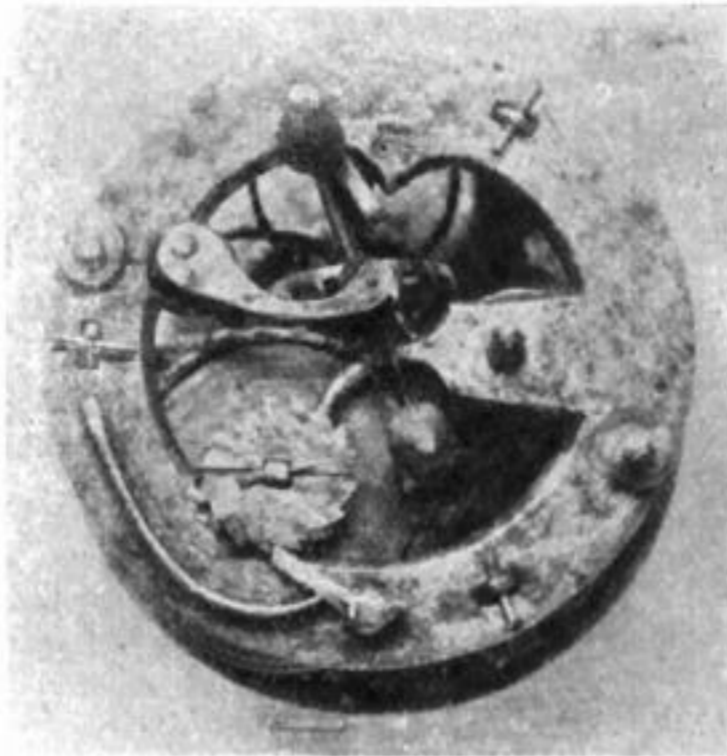
Werk aus Eisen mit Löffelunruh
