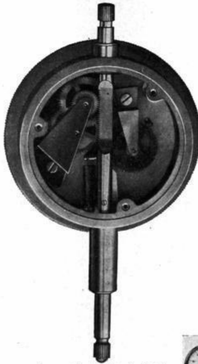
Innenansicht einer Kienzle - Meßuhr
