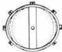
der Unruh ein durch Kaltrecken in der Kristallstruktur derart orientiertes Metall verwendet wird, daß die daraus verfertigte Unruh bei Temperaturschwankungen sich längs zweier sich schneidender Achsen ungleich ausdehnt, so daß diese Formänderung im Verein mit der bekannten Massenversetzung zum Ausgleich von Kompensationsfehlern nutzbar gemacht wird.
