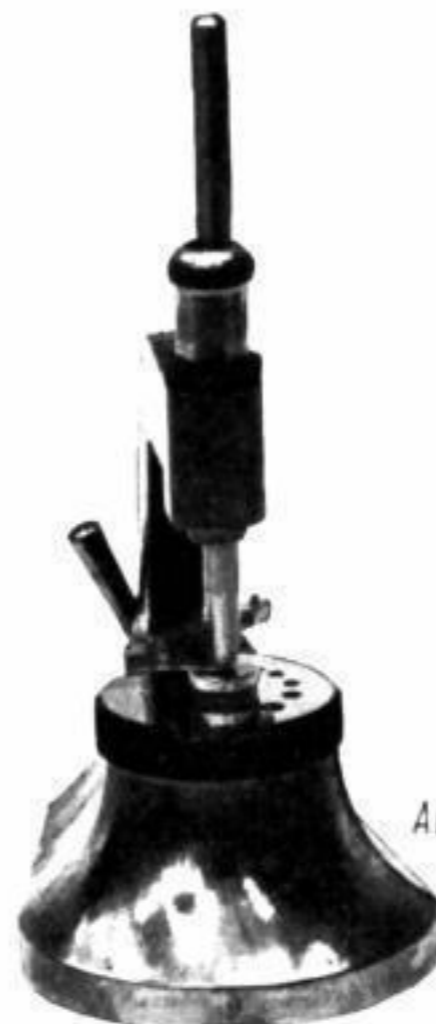
Abb. 5 Herausschlagen eines Lochsteines auf der Treibnietmaschine
