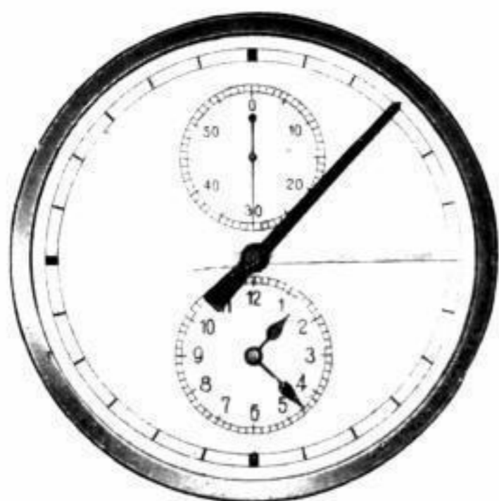
Abb. 14. Zifferblatt (Durchmesser 27 cm) und Zeiger einer „Siemens-Periodenkontrolluhr“. Der Kontrollzeiger mit Synchronmotorantrieb ist rot, der mit Uhrwerksantrieb ist weiß gefärbt. Beide Kontrollzeiger vollenden eine Umdrehung in 4 Minuten
