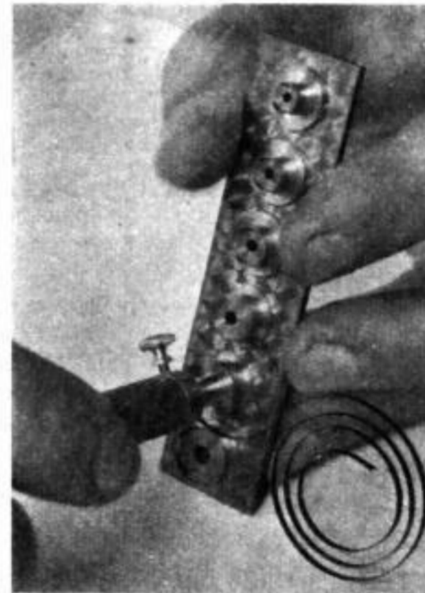
Die Feder wird aufgewunden. Man sieht, wie einfach es sich ausführen läßt
