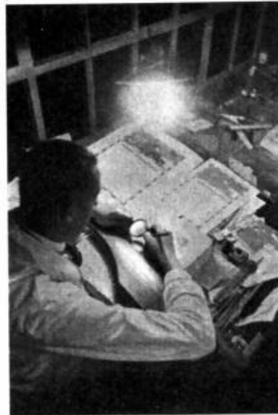
Abb. 1 Der Arbeitsplatz eines Lithographen bei un- zweckmäßiger Beleuchtung (Blendung, Licht- verlust, geringe Beleuchtungsstärke)
