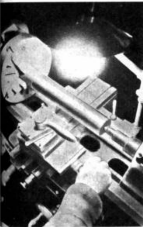
3 Schlechte Beleuchtung einer Drehbank
