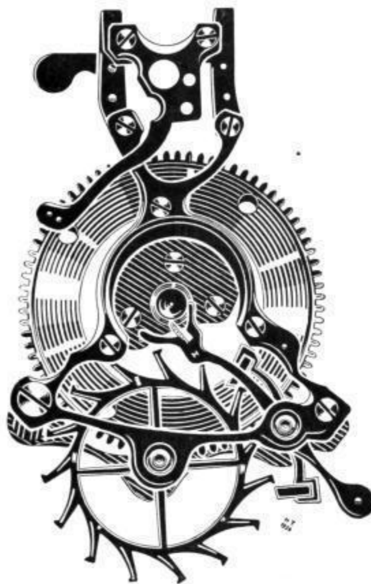
Abb. 3. Das Drehgestell, fünffach vergrößert
