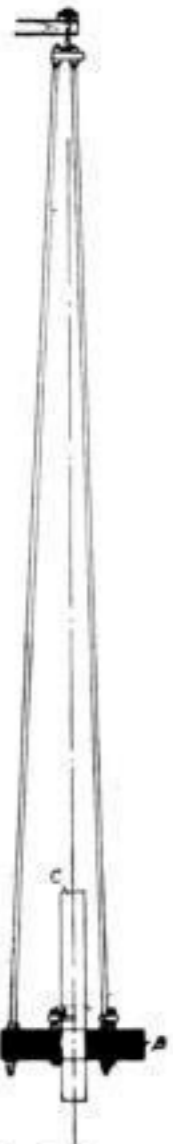
Abb. 1. Schema der Schußpendeluhr An dem etwa 8 cm langen Pendel mit der Masse B ist das Gehäuse C mit dem eigentlichen Uhrpendel befestigt
