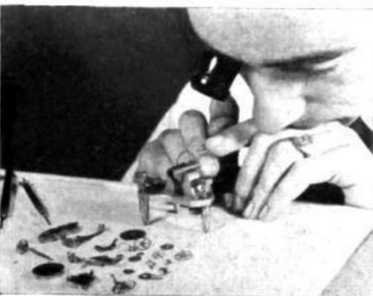
Abb. 4. Das Abwiegen der Unruh ist wichtig für den genauen Gang der Uhr. \frac{1}{10000} Gramm Ungleichheit verursacht eine Gangdifferenz von 40 sec am Tag.
