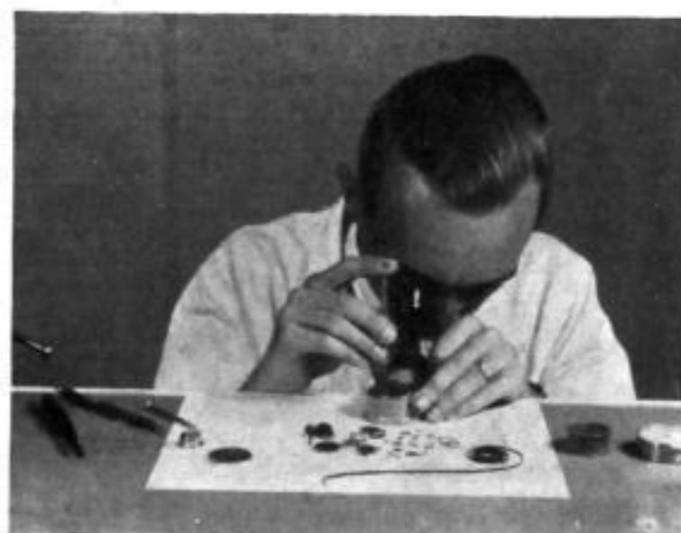
Abb. 8. Außerste Konzentration verlangt das Zusammensetzen der Uhr, damit kein Teil vergessen und keine Lagerstelle ungeölt bleibt.
