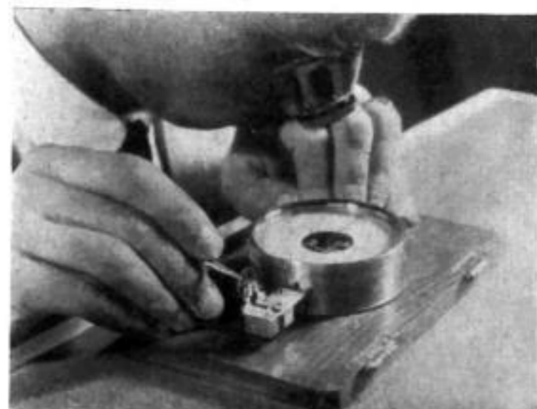
Abb. 7. Mit dem Mikrometer werden Bruchteile von 1/100 Millimeter gemessen.
