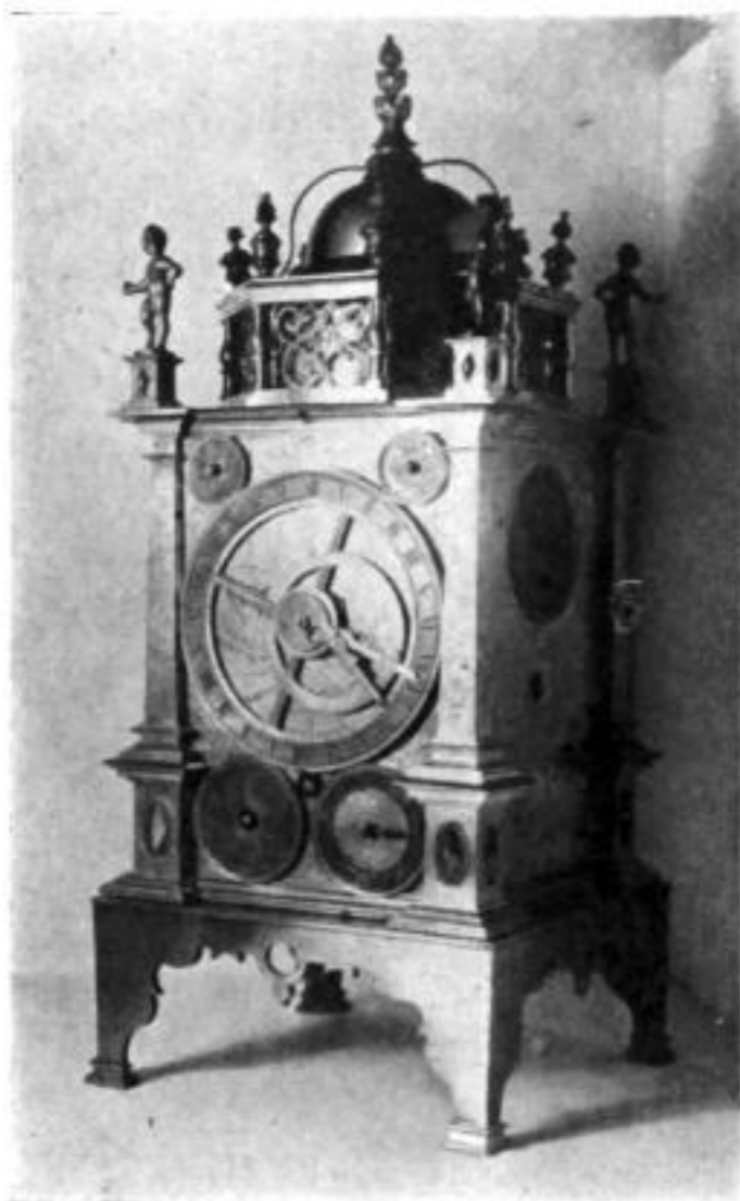
Foto: Uhrmacherkunst Große Türmbenuhr mit Zifferblättern an den vier Seiten, für Zeit- und astrono- mische Angaben
