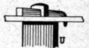
Abb. 7. Befestigung des Zifferblattes
