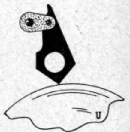
Abb. 8. Statt eines Weckerhammers ein umlaufender Klöppel
