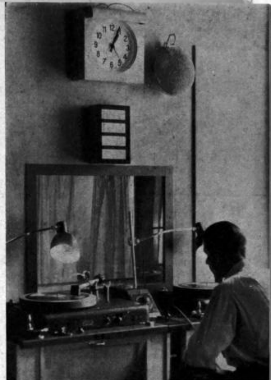
Werkaufnahme: Telefonbau und Normalzeit Rechts neben der sekundlich geschalteten Nebenuhr der elektrisch ausgelöste „Gongschlag“
