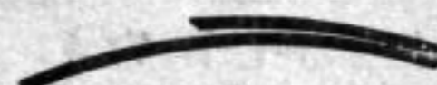
Der Endhaken 10 fach vergrößert, angenietet, angeschärft, gehärtet, gebogen, in richtiger Länge, poliert
