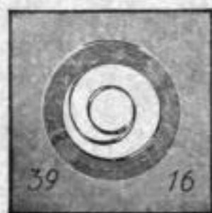
Feder in Metallplättchen statt im Drahring, mit Lagernummer, fertig zum Einsetzen
