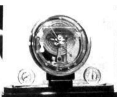
Eine neue Ausführung der Skelett-Barometer bringt Lufft & Co. in Verbindung mit kleinen Thermometern und Hygrometern.
