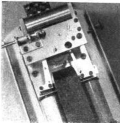
Kliniken, Sanatorien und Rundfunk verlangen zwar Sekundenzeit, aber ohne das störende Tickgeräusch der bisher bekannten Sekunden-springer. Telefonbau u. Normalzeit bringt ein geräuschloses Sekunden-Nebenuhrwerk mit pneumatischer Dämpfung.
